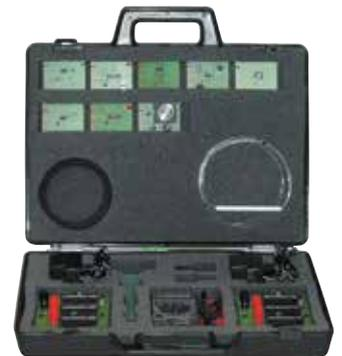
Contenidos: Módulos de transmisor y receptor, generador de frecuencia, micrófono con módulo amplificador, amplificador con altavoz, adaptador de voltaje, fibras ópticas, papel de lija fino, cilindros para experimentos de doblar, también se incluye un pequeño multímetro. El equipo se suministra en una maleta acolchada.
