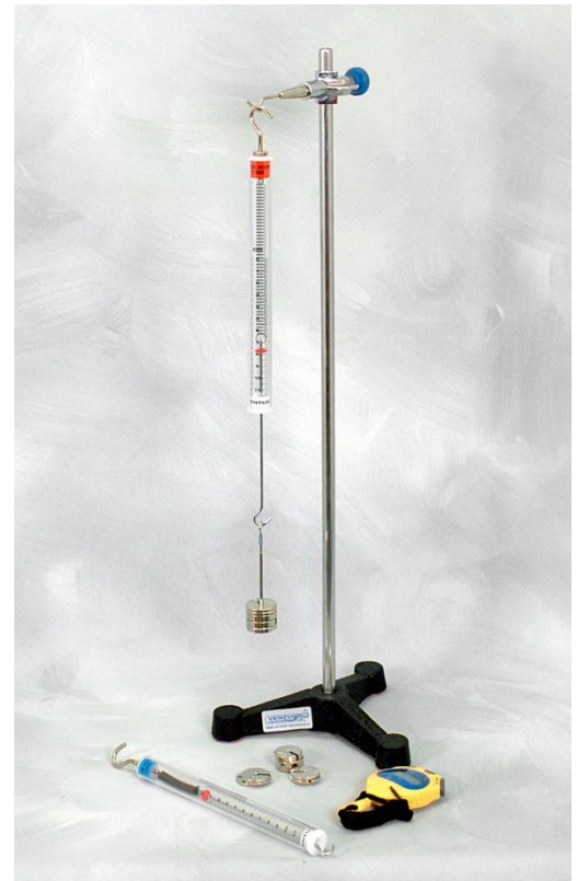
Ejemplo de montaje para la ley de Hooke y oscilaciones armónicas.
