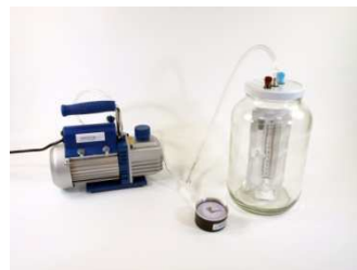
Principio del barómetro. Ley de Boyle
