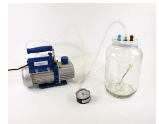
Dependencia del punto de ebullición con la presión
