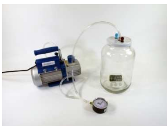
Propagación del sonido a baja presión
